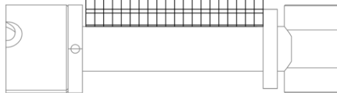
Figur 4.48 – Justering af klippehøjde for hydraulikbagrulle på Trident
