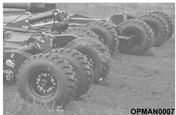
Abbildung 4.22 - Einsinken der Reifen
