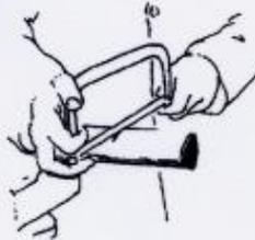
**b** Kürzen Sie überlange Wellenrohre ab. Scharfe Kanten abfeilen und Grate entfernen
