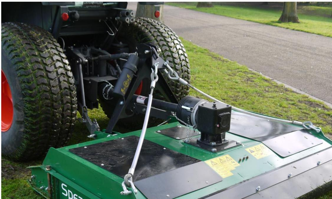
Befestigen Sie zuerst die Unterlenker an der Maschine, stellen Sie den Traktormotor ab und befestigen Sie dann die Zapfwelle. Anschließend kann der Oberlenker montiert werden. Stellen Sie den Oberlenker ein, um etwas Spielraum in den Anschlussblock zu bringen. Wenn der Oberlenker zu fest angezogen ist, folgt die Maschine nicht den Bodenkonturen.
